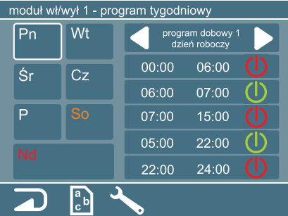
Okno programatora tygodniowego modułu włącz / wyłącz.
