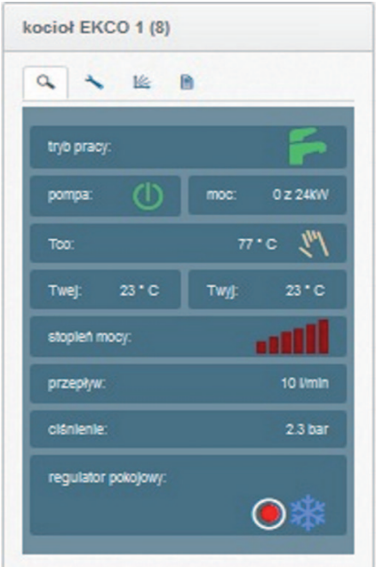
Przykładowe okno podglądu ustawień parametrów kotła EKCO
